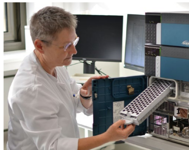
Einer der Ansatzpunkte zur Individualisierung: Bestimmung der Medikamentenspiegel mittels Massenspektrometrie zur personalisierten Psychopharmaka-Therapie.
