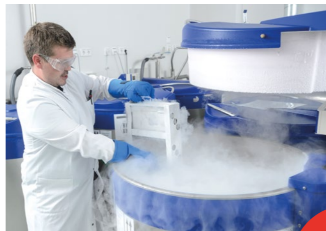
Gewonnene Stammzellen werden im GMP-Reinraumlabor unter hochsterilen Bedingungen tiefgefroren und in speziellen Stickstofftanks bei Temperaturen unter -140^{\circ}\text{C} gelagert.
