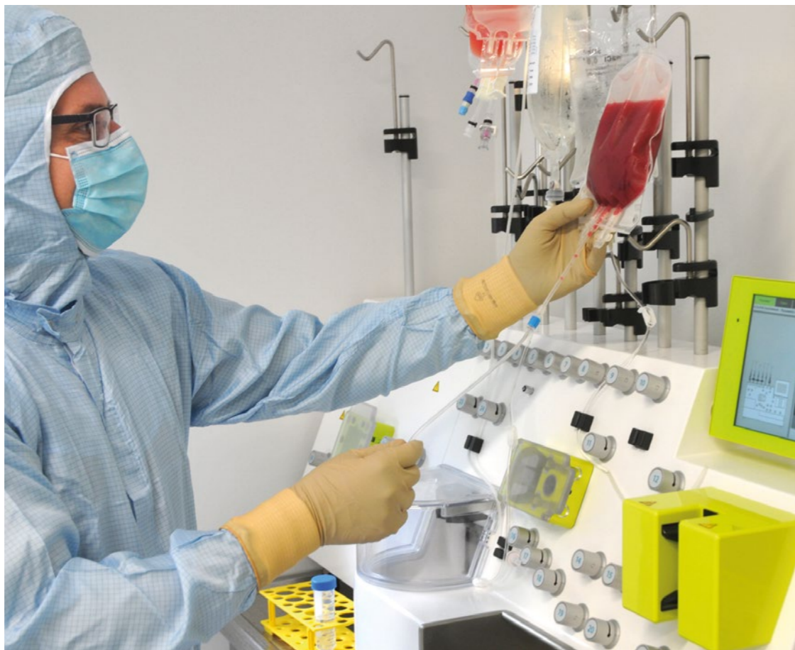
Der Leiter der Qualitätskontrolle, Dipl.-Biol. Johannes Rachor, im Reinraumbereich des GMP-Zelltherapie-Labors beim Bestücken eines neuen, vollautomatischen Zellseparators.
