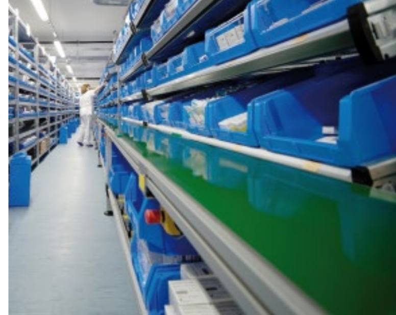
In der Arzneimittellogistik werden die aus den Regalen entnommenen Medikamente auf das grüne Förderband davor gelegt.
