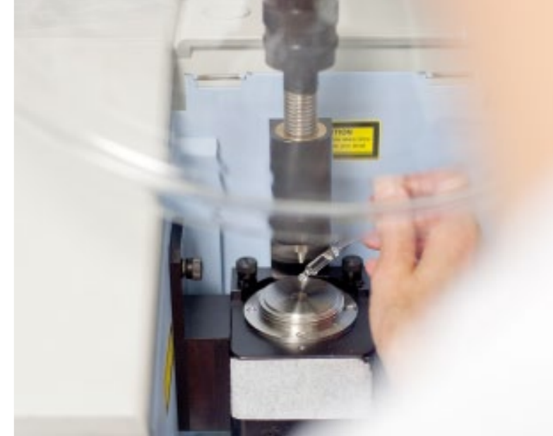
Zur Eigenherstellung von Medikamenten gehört auch eine umfassende Qualitätskontrolle, hier zum Beispiel per Infrarot-Spektroskopie.
